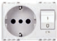
20276.B 16 A P30 250 V~, 1P+N C 16 - 3 modules. Depth: 39,8 mm
