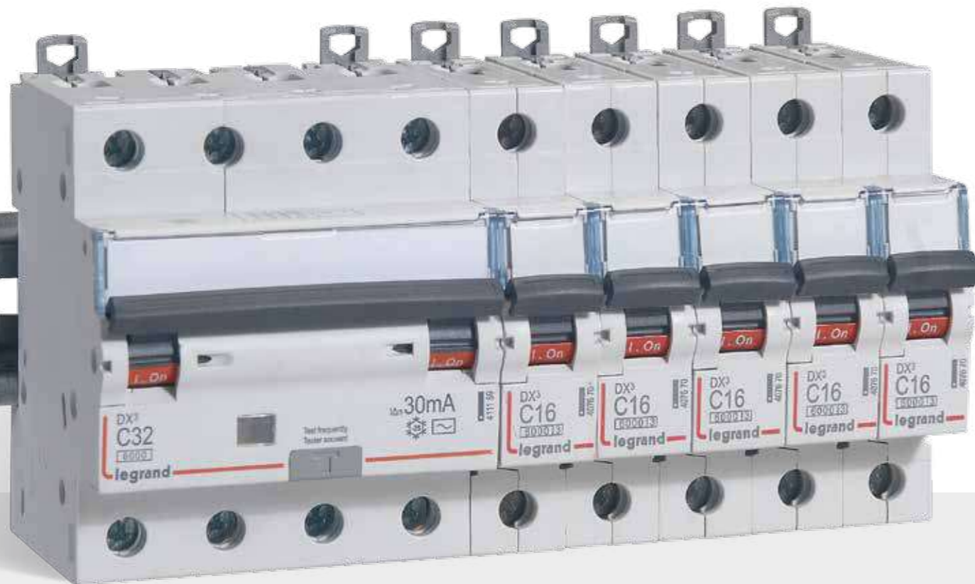
Компактен размер: от 10 до 32А 4-полюсни DX 3 автоматични прекъсвачи с ДТЗ само 4 модула, защитена неутрала.
