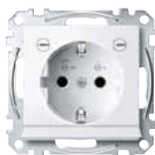
Контактен излаз шуко с излаз за LED светлинен индикатор, 16 A, 250 V AC, DIN 49440
